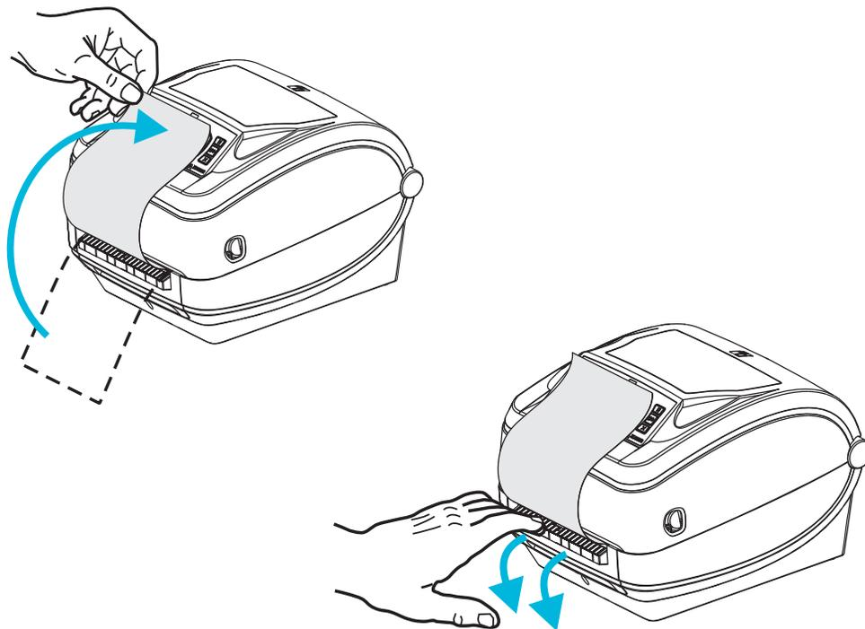
3. Ziehen Sie das Trägermaterial durch den Schlitz zwischen der Klappe des Etikettenspenders und dem Drucker nach unten.
