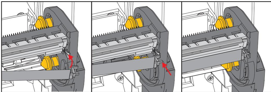
7. Überprüfen Sie, ob der Druckkopf mit etwas Druck nach oben und unten bewegt werden kann und dann an der entsprechenden Position bleibt.
