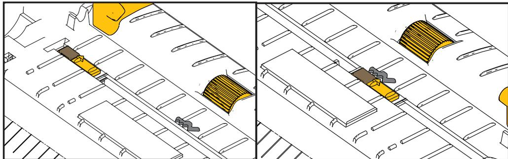
4. Ziehen Sie das Medium so weit hindurch, dass es aus der Vorderseite des Druckers herausragt. Überprüfen Sie, ob sich die Rolle frei drehen lässt. Die Rolle darf nicht im Medienfach aufliegen. Die zu bedruckende Seite des Druckmediums muss nach oben zeigen.
