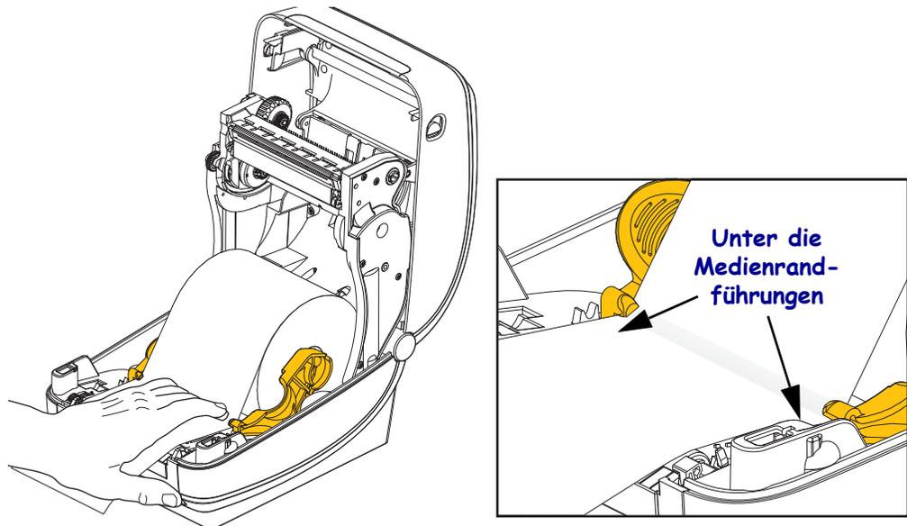
6. Schließen Sie den Drucker. Drücken Sie die Abdeckung nach unten, bis sie hörbar einrastet. Möglicherweise müssen Sie eine manuelle Kalibrierung für die Medien durchführen, um die Sensoren des Druckers und die Einstellung für die Etikettenlänge anzupassen. Siehe [Manuelle Kalibrierung – Medien auf Seite 78](#). Führen Sie bei Verwendung von RFID-Medien eine RFID-Kalibrierung durch. Siehe dazu [Menü RFID auf Seite 68 – RFID CALIBRATE \(RFID-Kalibrierung\)](#).
