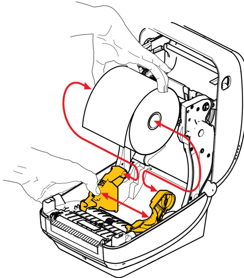
3. Vergewissern Sie sich, dass sich der bewegliche Sensor für schwarze Markierungen in der Mittelposition befindet. Dies ist die Standardbetriebsposition für die Medienabtastung. Wenn sich der Sensor nicht in der Standardposition zur Abtastung von Etikettenszwischenräumen befindet, erkennt der Drucker nur Medien mit schwarzen Markierungen und Stanzungen.
