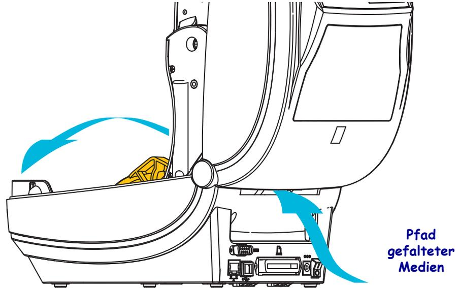
2. Passen Sie die Stoppstellung der Medienführung mithilfe des grünen Einstellrads an. Legen Sie die Stoppstellung mithilfe eines Streifens der gefalteten Medien fest. Wenn Sie das Einstellrad in Ihre Richtung drehen, wird die Öffnung der Medienführung breiter. Durch Drehen des Einstellrads in die andere Richtung wird die Öffnung der Medienführung schmaler.
