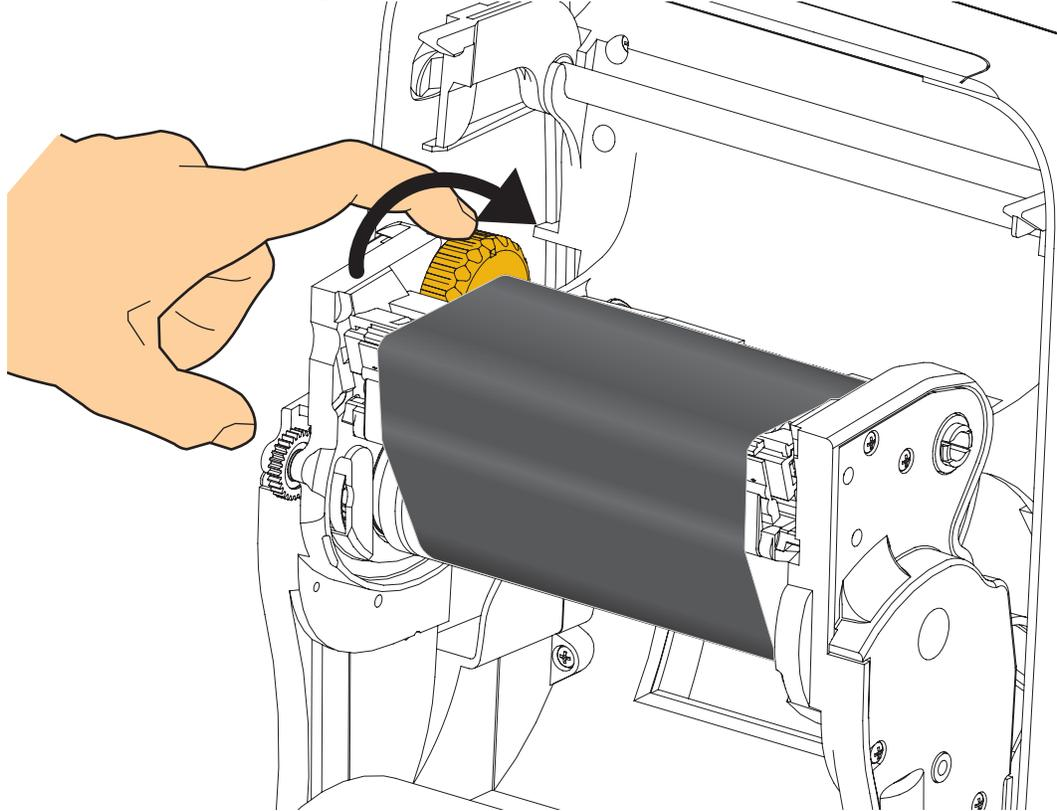
5. Überprüfen Sie, ob das Druckmedium eingezogen und druckbereit ist, und schließen Sie anschließend die Druckerabdeckung.
