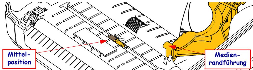
2. Entfernen Sie die ersten 80 mm (3 Zoll) der Etiketten vom Träger. Ziehen Sie den leeren Träger über die Auflagewalze (Antriebswalze) und positionieren Sie die führende Kante des ersten Etiketts unter den Medienführungen.
