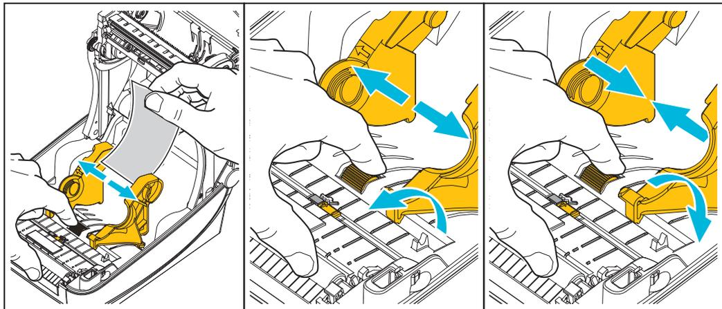
3. Führen Sie die Druckmedien durch den Schlitz an der Rückseite des Druckers.
