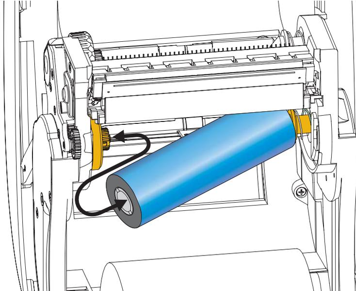
Drehen Sie die Rolle so, dass sich die Aussparungen in der richtigen Position befinden und die Rolle beim Einsetzen links an der Nabe der Vorratsspule einrastet.
