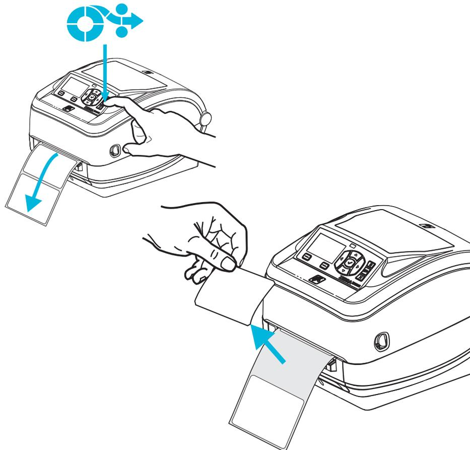
2. Schlagen Sie das Trägermaterial über den Drucker zurück, und öffnen Sie die Klappe des Etikettenspenders.
