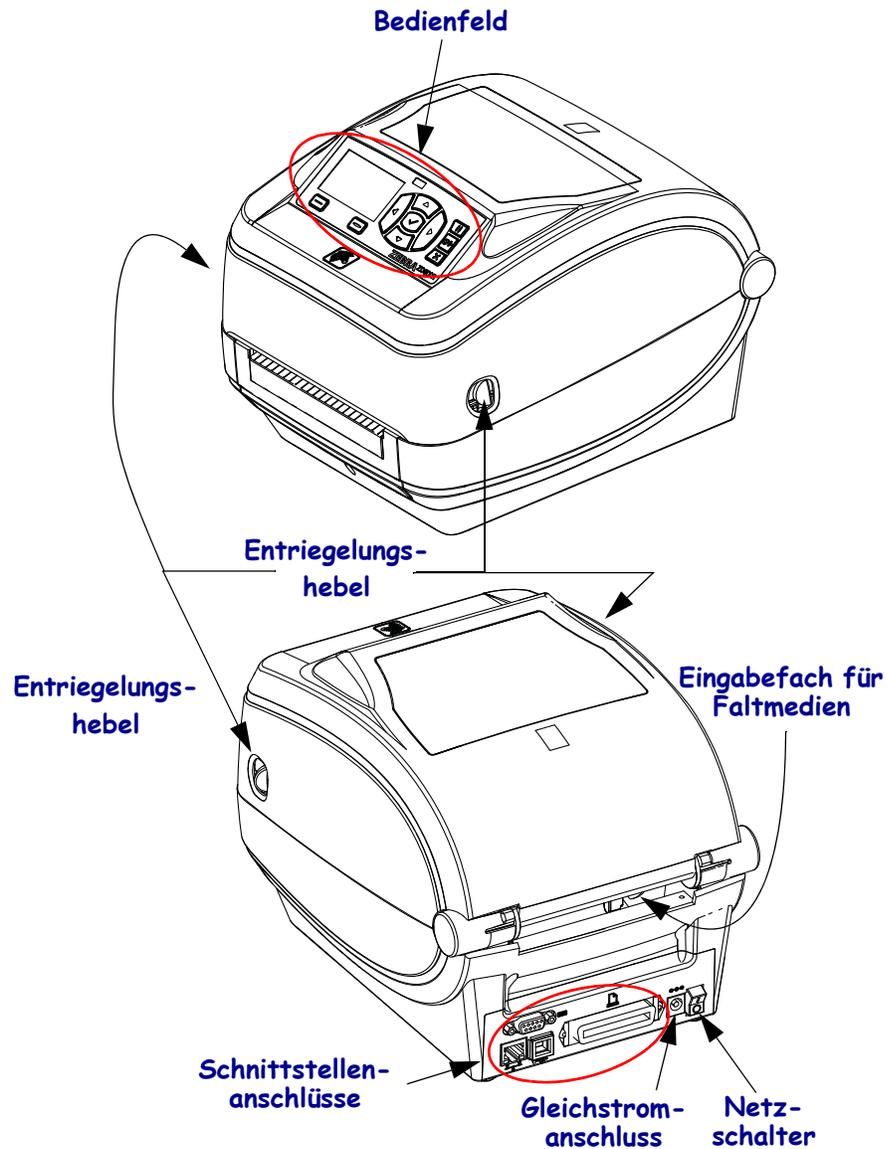
Abbildung 2 • Druckerteile (Fortsetzung)
