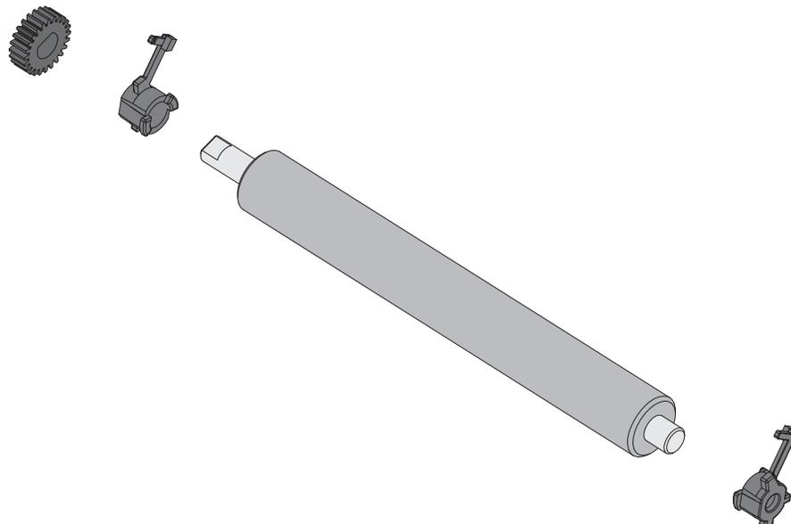
7. Halten Sie die Walze so, dass sich das Zahnrad auf der linken Seite befindet, und setzen Sie sie in den unteren Druckerrahmen ein.
