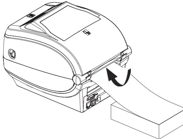
4. Föhren Sie die Druckmedien durch die Medienföh rung und die Rollenhalterungen.
