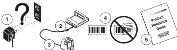
2. Sicherstellen, dass das Interfacekabel am Endgerät richtig angeschlossen ist. Wenden Sie sich an Ihr zuständiges Technikpersonal oder ziehen Sie das Endgeräthandbuch zurate, um einen ordnungsgemäßen Anschluss des Scanners sicherzustellen.
