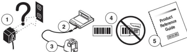
2. Compruebe que el cable de interfaz está perfectamente acoplado al equipo central. Pida ayuda al personal de asistencia técnica o consulte el manual del sistema central para comprobar que el escáner esté correctamente conectado.
