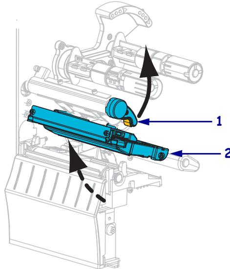
3. Bringen Sie das Farbband in Position, indem Sie das lose Ende im Uhrzeigersinn abrollen.
