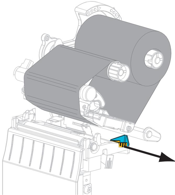
5. Schieben Sie die Medien unter die Medientänzeinheit und den Druckmechanismus. Schieben Sie das Medium so weit hindurch, dass es aus der Vorderseite des Druckers herausragt.
