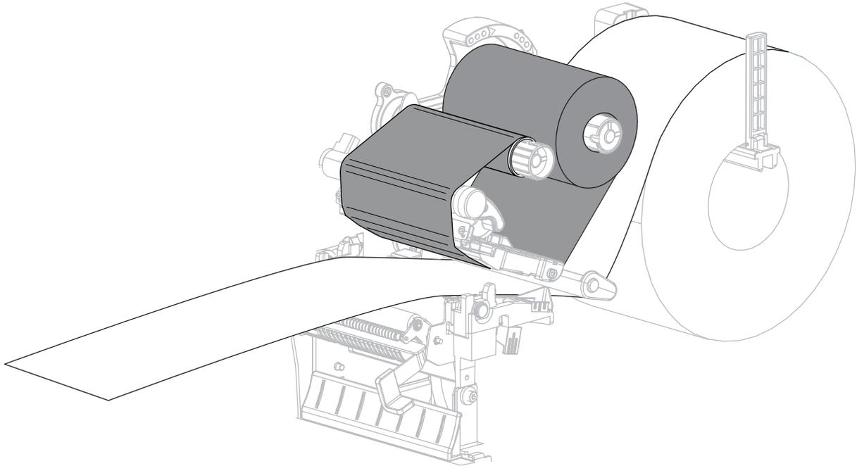
16. Entfernen Sie die freigelegten Etiketten, sodass nur das Trägermaterial übrig bleibt.
