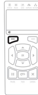
Drücken Sie die **linke Auswahltaste**, um das Startmenü zu verlassen und zur Leerlaufanzeige zurückzukehren. Der Drucker kehrt automatisch bei 15 Sekunden Inaktivität im Startmenü zur Leerlaufanzeige zurück.
