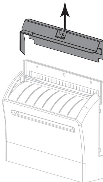
6. Wenn erforderlich, drehen Sie die Schneide so lange, bis das V-förmige Schneidmesser vollständig freigelegt ist (1).
