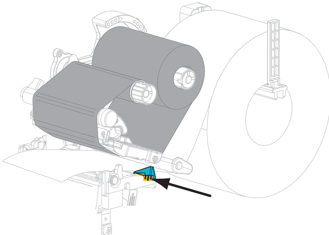
28. Drehen Sie den Hebel zum Öffnen des Druckkopfes im Uhrzeigersinn, bis der Druckkopf einrastet.
