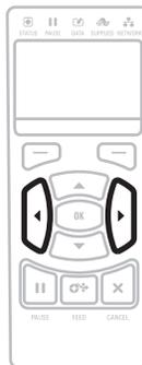
Drücken Sie die **Pfeil-nach-links-** oder die **Pfeil-nach-rechts-Taste**, um einen Bildlauf durch die Elemente in einem Benutzermenü durchzuführen.
