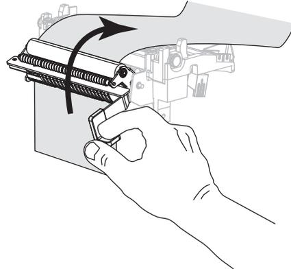
9. Drehen Sie den Hebel zum Öffnen des Druckkopfes im Uhrzeigersinn, bis der Druckkopf einrastet.
