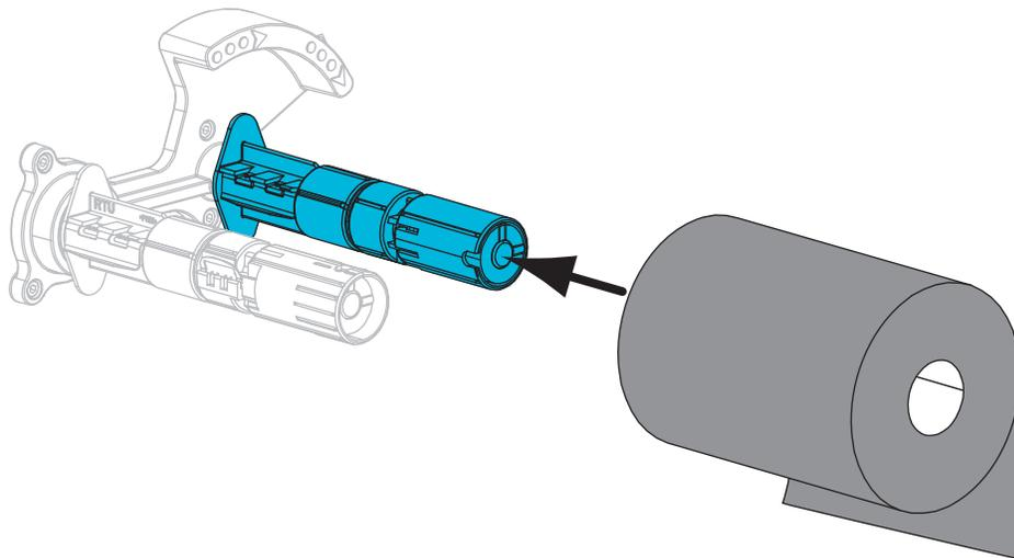
5. Der Drucker wird mit einem leeren Farbbandkern auf der Farbband-Aufwickelspule geliefert. Falls dieser Kern nicht mehr da ist, setzen Sie einen leeren Farbbandkern auf die Farbband-Aufwickelspule. Schieben Sie den Kern so weit wie möglich nach hinten.
