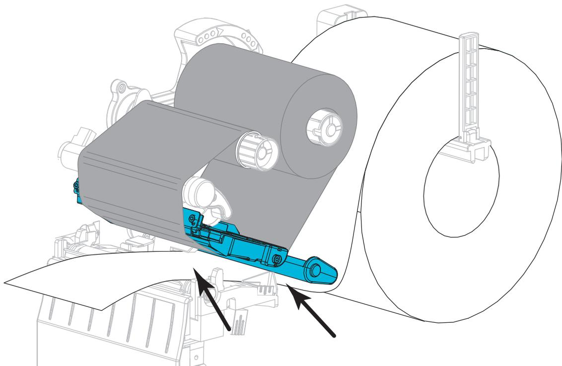
6. Stellen Sie sicher, dass das Medium durch den Schlitz im Durchlichtsensor (1) und unter der inneren Medienrandführung (2) durchgeführt ist. Das Medium sollte das hintere Ende des Schlitzes am Durchlichtsensor gerade berühren.
