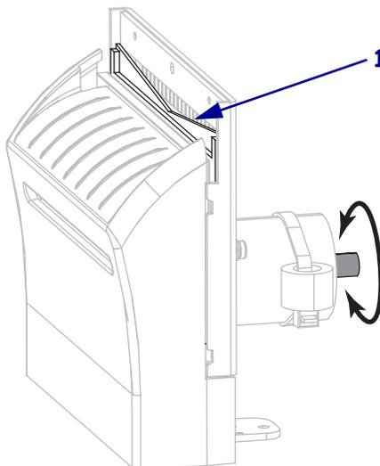
7. Wischen Sie mit dem Stäbchen aus dem Wartungskit (Teilenummer 47362) über die obere Schneidefläche (1) und das Schneidmesser (2). Anstelle des Wartungskits können Sie auch einen sauberen Tupfer verwenden, der in eine Lösung aus Isopropylalkohol (mindestens 90 %) und entionisiertem Wasser (höchstens 10 %) eingetaucht wurde. Warten Sie, bis sich das Lösungsmittel verflüchtigt hat.
