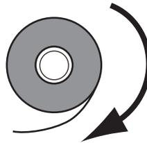
4. Setzen Sie die Farbbandrolle auf die Farbband-Vorratsspule. Drücken Sie die Rolle so weit wie möglich nach hinten.
