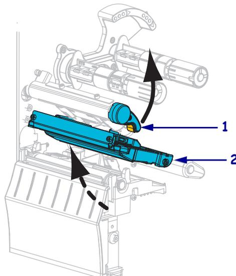
3. Entfernen Sie das Farbband (sofern verwendet) und die Medien.
