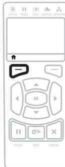
Drücken Sie die **linke Auswahl**taste, um in das Startmenü zurückzukehren. Der Drucker kehrt automatisch bei 15 Sekunden Inaktivität im Benutzermenü zum Startmenü zurück.
