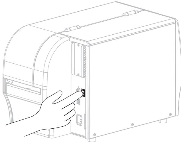
Der Drucker wird hochgefahren und führt einen Selbsttest aus. Der Drucker zeigt den Status über die Anzeige auf dem Bedienfeld an (siehe [Tabelle 14 auf Seite 127](#) für die Erklärung der verschiedenfarbigen LEDs und Kombinationen).
