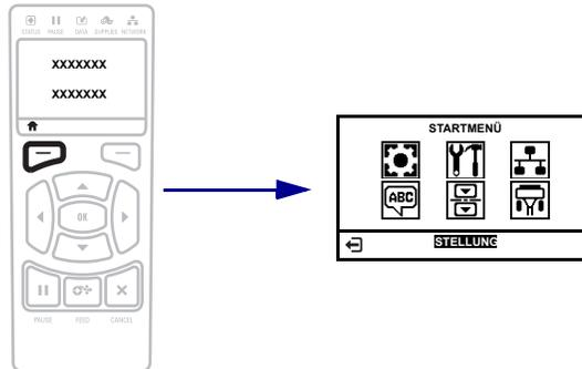
Drücken Sie die **linke Auswahltaste** (Abbildung 5 auf Seite 17) in der Leerlaufanzeige, um zum Startmenü des Druckers zu gelangen (Abbildung 6 auf Seite 17).
