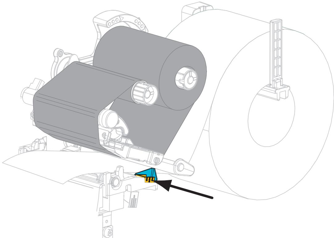
9. Drehen Sie den Hebel zum Öffnen des Druckkopfes im Uhrzeigersinn, bis der Druckkopf einrastet.
