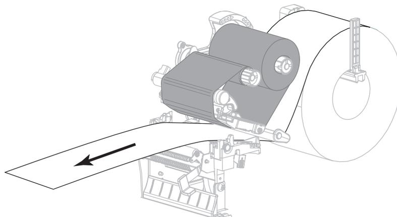
4. Entfernen Sie die freigelegten Etiketten, sodass nur das Trägermaterial übrig bleibt.
