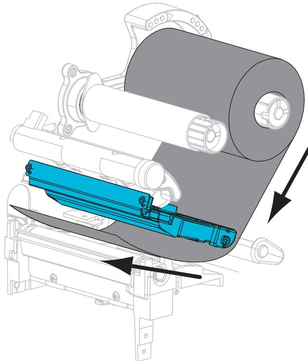
7. Wickeln Sie das Farbband im Uhrzeigersinn um den Kern auf der Farbband-Aufwickelspule. Drehen Sie die Spule, bis das Farbband mehrere Male um die Spule gewickelt ist.
