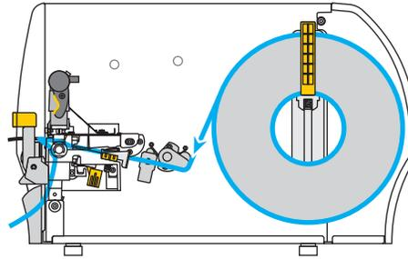
14. Drücken Sie den Freigabehebel des Abziehmechanismus nach unten, um die Abzieheinheit zu öffnen.
