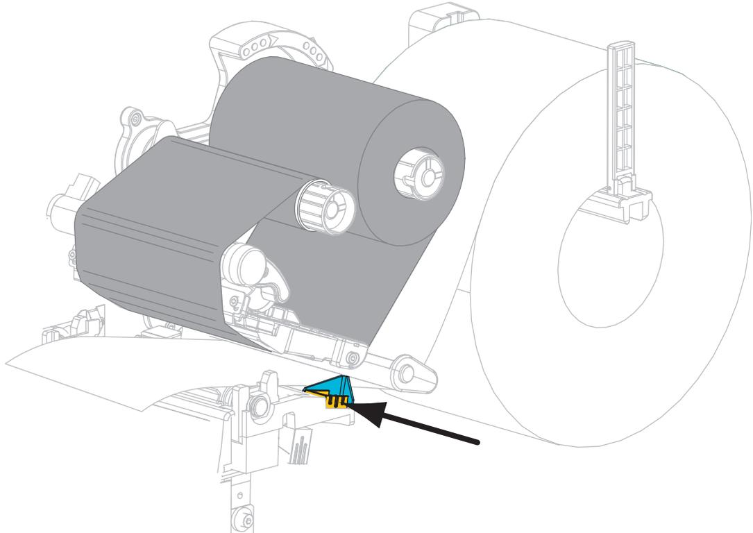
**21.** Drehen Sie den Hebel zum Öffnen des Druckkopfes im Uhrzeigersinn, bis der Druckkopf einrastet.
