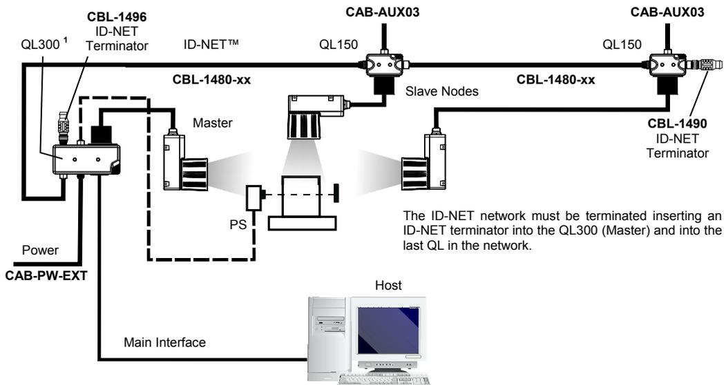
**Figure 113 - ID-NET™ Synchronized Layout
