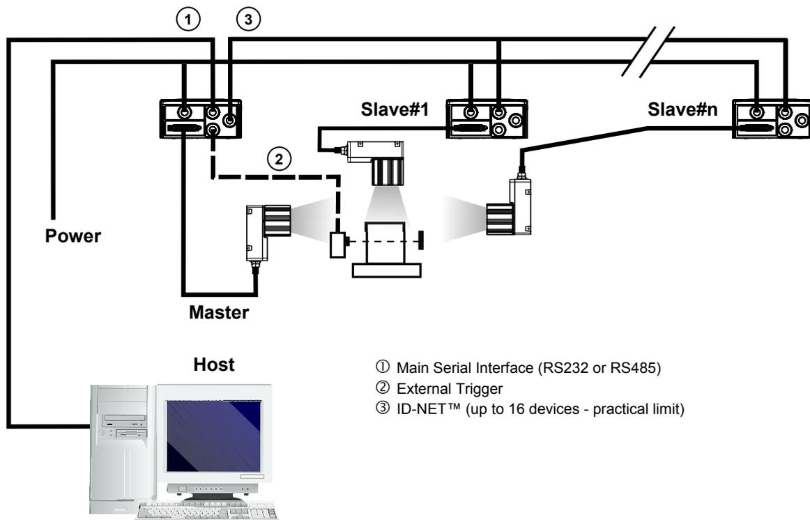
Figure 111 – ID-NET™ M/S Synchronized Layout
