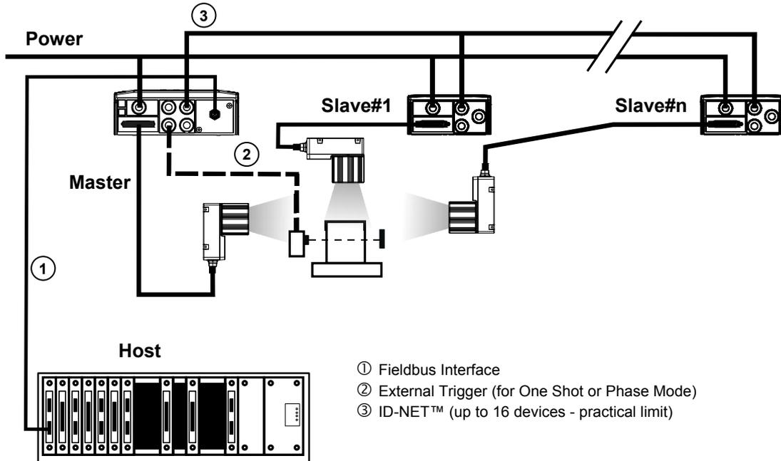
Figure 117 – ID-NET™ Fieldbus M/S Synchronized Layout
