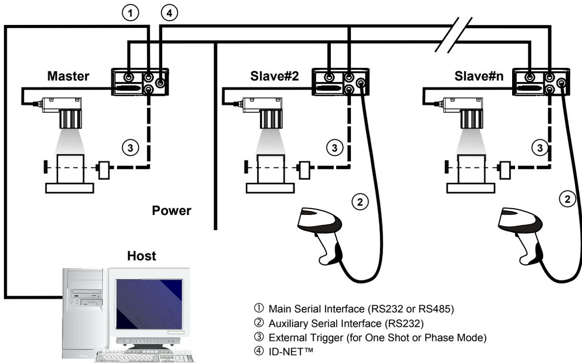
Figure 110 – Pass-Through On ID-NET™ Layout
