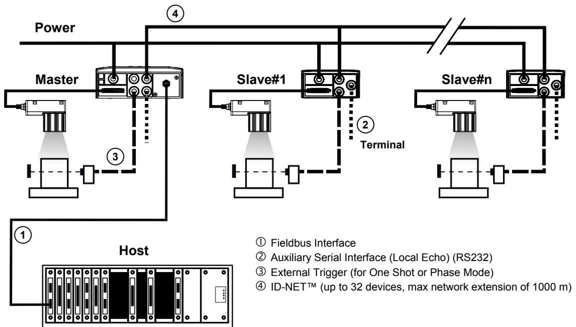
Figure 118 – ID-NET™ Fieldbus M/S Multidata
