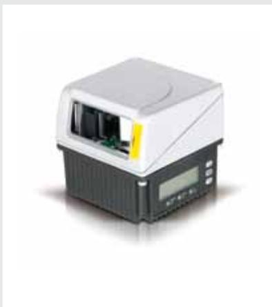
Der DS6400 ist ein hochleistungsfähiger Industrie-Laser-Scanner mit Step-a-Head™ Technologie. Er ermöglicht einen Leseabstand von 300 mm bis 2500 mm. Des weiteren verfügt er über FLASH™ - das dynamische Fokussystem, einen erweiterten Decoder zur Code-Rekonstruktion (ACR4), Display und Tastatur sowie die neue GENIUS™ Konfigurations-Software und die PackTrack™ Funktion.
