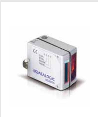
Das stationäre Barcode-Lesegerät DS2200 ist ein ultrakompakter Laserscanner mit integriertem Decoder, einer Abtastrate von 500 Scan/Sek. und einem Leseabstand von 50 bis 220 mm. Der DS2200 ist eine wirtschaftliche Lösung für OEM-Applikationen.
