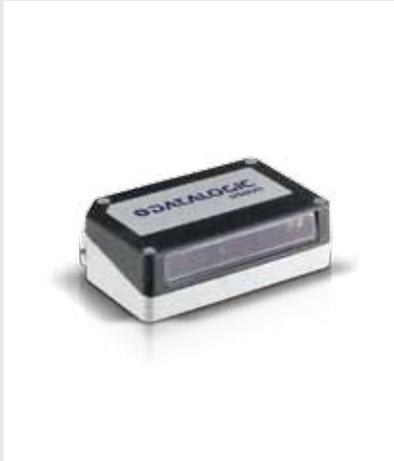
Das stationäre DS1100 Barcode-Lesegerät ist ein und preiswerter Laserscanner, der sich auszeichnet durch sein sehr kompaktes Format, Ein-/Aus-Softwarebefehle, sein großes Lesefeld mit kurzer Lesedistanz, sein geringes Gewicht (weniger als 100 g), integrierten RISC Decoder, einer Abtastrate von 500 Scan/Sek., zwei serielle Hochgeschwindigkeits-Schnittstellen und sein robustes IP65-Industriegehäuse.
