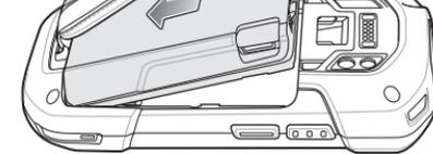
4. Legen Sie den Akku in das Akkufach und drücken Sie den Akku nach unten, bis er einrastet.
