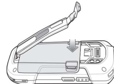
5. Legen Sie die Klammer der Handschlaufe in den Schlitz für die Handschlaufe, und ziehen Sie diese nach unten, bis sie einrastet.
